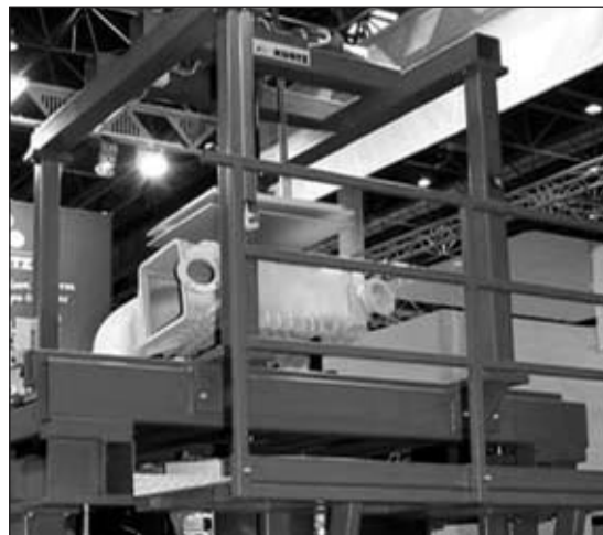
4. ábra. Kisnyomású kemence felhasználásával, pontos homokformába öntött, tömör alumínium alkatrész
