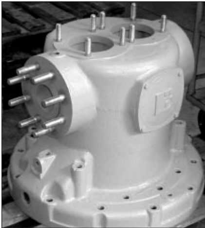
■ 3. ábra. Készre munkált, nyomáspróbán átessett kompresszorhenger, EN-GJL-250, 560 kg, 48 bar üzemi nyomás
