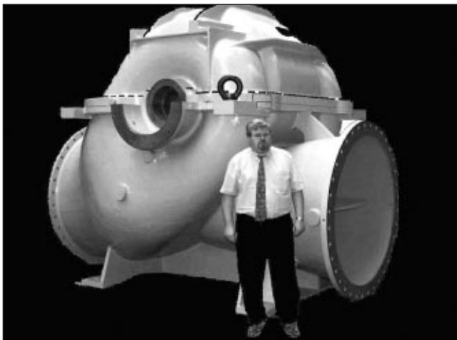
■ 6. ábra. Dr. Sohajda József és cégének egyik különleges terméke, a Weir-szivattyúház, melynek alsó része 18 tonnás, a felső fedél 7 tonnás vasöntvény. 2004-ben 10 garnitúrát öntöttek és készre munkálva szállítottak ausztrál atomerőműi megrendelésre
