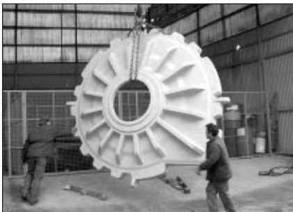
■ 4. ábra. Zagyszivattyúfél, EN-GJS-600-3, 9800 kg
