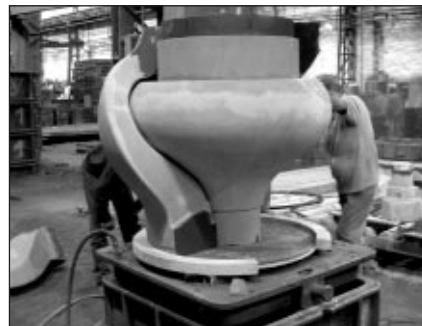
■ 11. ábra. Vezetőlapátház magcsomagjának összeállítása sablonban, EN-GJL 250, 2350 kg
