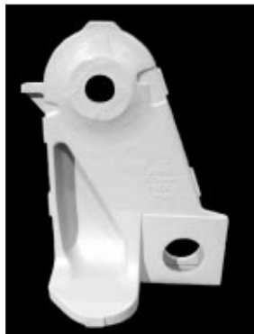
■ 5. ábra. Láncvezető villa kikötői konténerosztályozó daruhoz, EN-GJS-500-7, 680 kg, 9 részen röntgenvizsgálatra kötelezett
