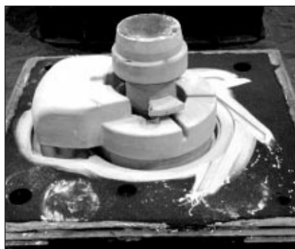
■ 10. ábra. Csapágytartó alsó formafele a magok berakása után, EN-GJL 250, 140 kg
