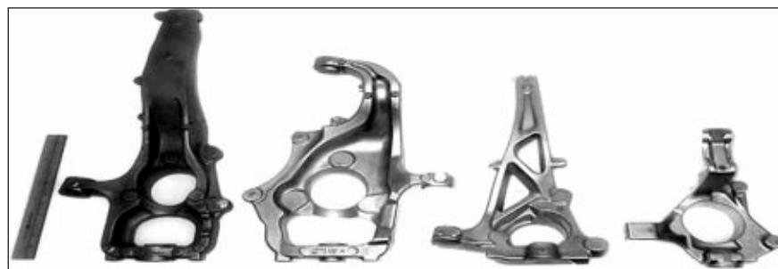
■ 3c ábra. A PCPC-eljárással gyártott szerkezeti gépkocsiöntvények példái, a mérettartomány: 2,5–7,0 kg (Internet-fotó)
