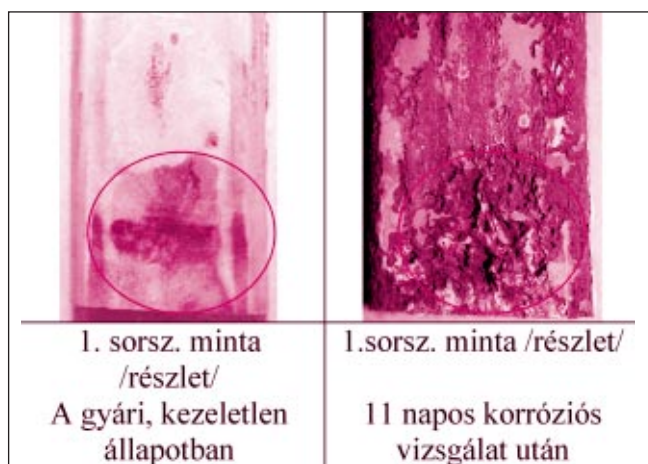
■ 7. ábra. Az erősebben szennyezett öntvényrészek korróziós viselkedése egyazon (1. sorsz.) mintánál
