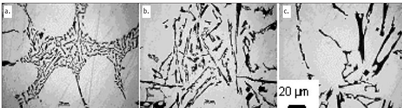
6. ábra. Szövetképek a termikus analízis során készített próbatestek csiszolatairól: a. Szálás (2-es minta: Sr: 89,1 ppm), b. Tűs (4-es minta: Sr: 61,6 ppm), c. Lemezes (8-as minta: Sr: 37,2 ppm)
