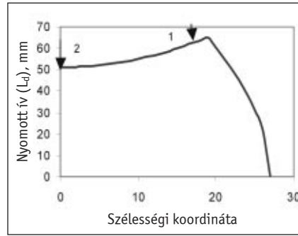
■ 6. ábra. A rúd nyomott felülete az ovál üregben
