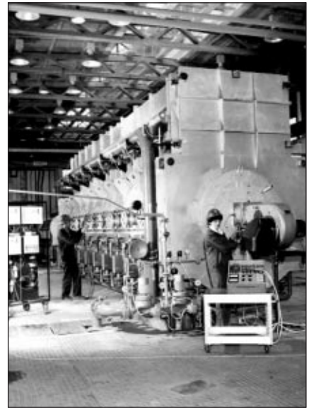
17. ábra. Égővizsgálat a Lángvizsgáló Üzem kísérleti kemencéjén
