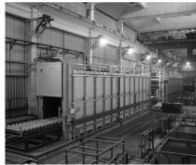
Gönggős fenekű hőkezelő berendezés, Le Belier Zrt. (2002)
