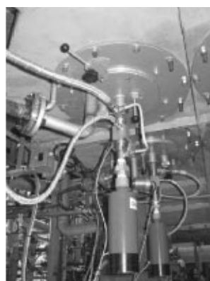
BGT-1600 ( \text{NO}_x ) típusú égő, MOL Nyrt. Dunai Finomító (2006)
