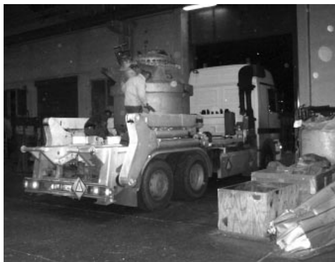
1. kép. Folyékony alumíniumötvözet közúti szállítása
