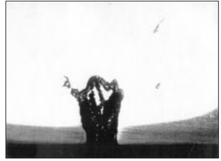
■ 3. kép. Ugyanaz, csak 10x-es nagyításban. Jól láthatók a retorta falába vezető csatornák
