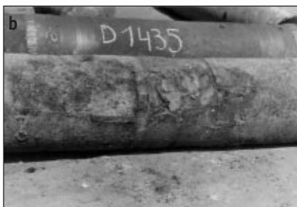
■ 5. a-c kép. Meghibásodott (behorpadt, repedt vagy izzadmányos) retorták, melyeket a Diósgyőri Acélöntöde homokformába öntött
