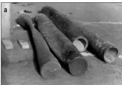
■ 5. a-c kép. Meghibásodott (behorpadt, repedt vagy izzadmányos) retorták, melyeket a Diósgyőri Acélöntöde homokformába öntött
