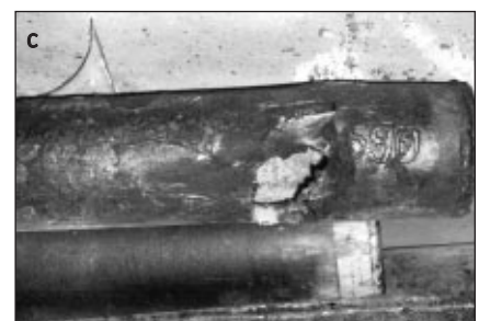
■ 5. a-c kép. Meghibásodott (behorpadt, repedt vagy izzadmányos) retorták, melyeket a Diósgyőri Acélöntöde homokformába öntött
