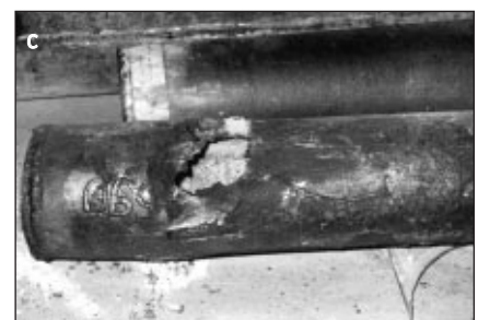
■ 5. a-c kép. Meghibásodott (behorpadt, repedt vagy izzadmányos) retorták, melyeket a Diósgyőri Acélöntöde homokformába öntött
