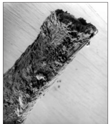
■ 10. ábra. Egy másik drótkötél korróziós kifáradás miatt kontrakció nélkül szakadt elemi szála összehasonlításhoz (N=300x)
