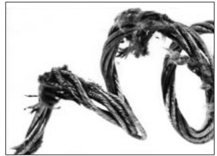
■ 3. ábra. Fokozott roncsolódást okozott a hurokképződés
