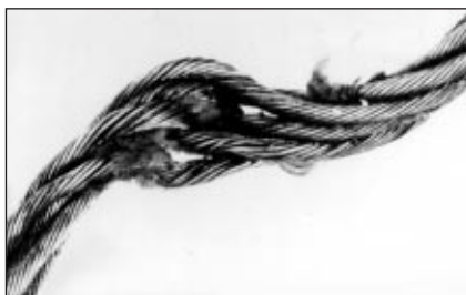
■ 4. ábra. Jellegzetes roncsolódott rész a szakadás közelében
