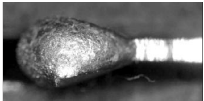
■ 3. ábra. A kezelt, átötvözött fogcsúc az élézés előtti állapotában
