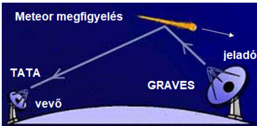
2. ábra. A GRAVES nagyteljesítményű műholdradar meteor megfigyelési elve
