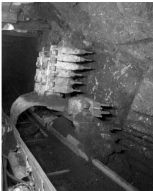
3. ábra: Gépi jövesztés Gleithobel berendezéssel
