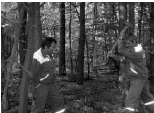
2. kép: Talajgáz mintavevő szonda leverése a terepen
