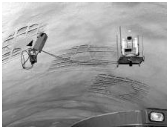
2. ábra: Vágatban elhelyezett mérőállomás
