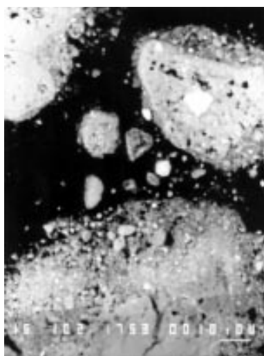
4. a ábra: 125 °C-on 5 órán át kezelt bauxitminta pásztázó elektronmikroszkópos képe
