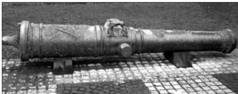
■ 5. ábra. 24 fontos osztrák elöltöltő ágyúcső [14]
