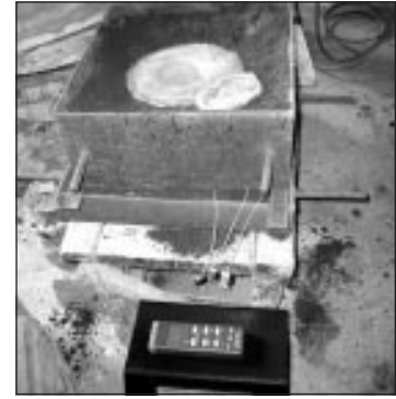
9. ábra. A mérésre kész forma
