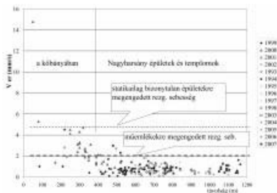
2. ábra: Az eredő rezgési sebesség a távolság függvényében (Nagyvárad 1999-2007)
