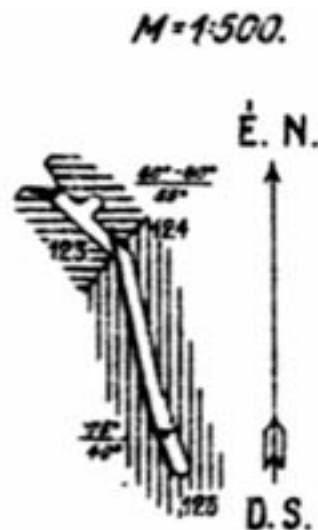
8. ábra: A Nógrádi bánya földtani szelvénye (vízszintes sraffozás: törmelékes nyirok, függőleges sraffozás: agglomerátum vagy breccsa, Liffa A. – Vígh Gy. 1937)
