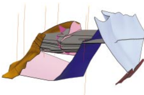
4. ábra: Az Északi tömb 3D szerkezeti modellje a készletszámításba vont széntelepekkel
