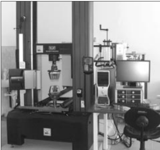
1. ábra: Instron 5982 univerzális anyagvizsgáló berendezés
