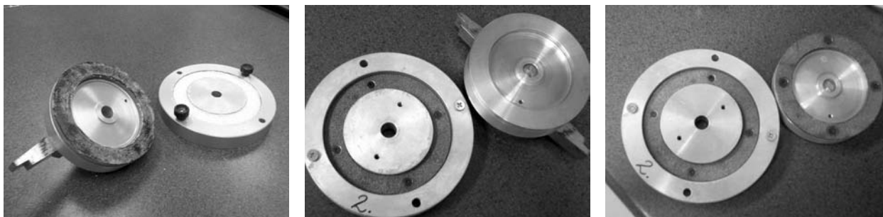
2. ábra: Az alsó nyíródobozba helyezett talaj (bentonit), az azt alulról határoló szűrőkö és a kontaktrendszer „mesterséges anyagu” elemei: a formára vágott gumilap, az alumíniumlemez és a szinterezett bronz szűrőkö
