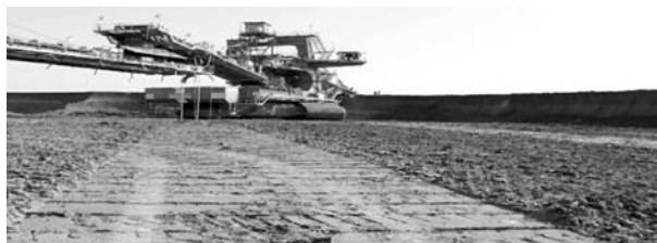
18. és 19. ábra: GPS-üzem alatt kialakított lavírsíkok
