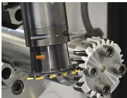
6. ábra. Ferde fogazatú hengeres fogaskerék előállítás 'millturn' technológiával [18]
