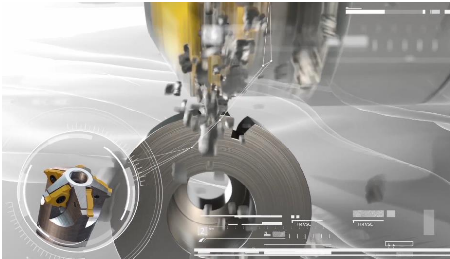
9. ábra. Fogmarás váltólapkás szármaróval egyenes fogirányú hengeres kerék esetén [22]
