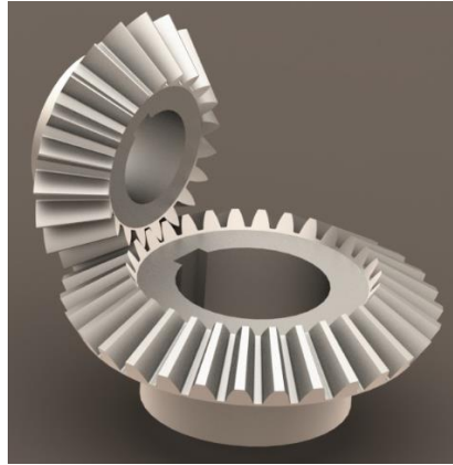
11. ábra. Egyenes fogazatú kúpkerékpár tervezése [2]
