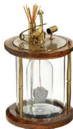
2. ábra: Döbereiner öngyújtója
