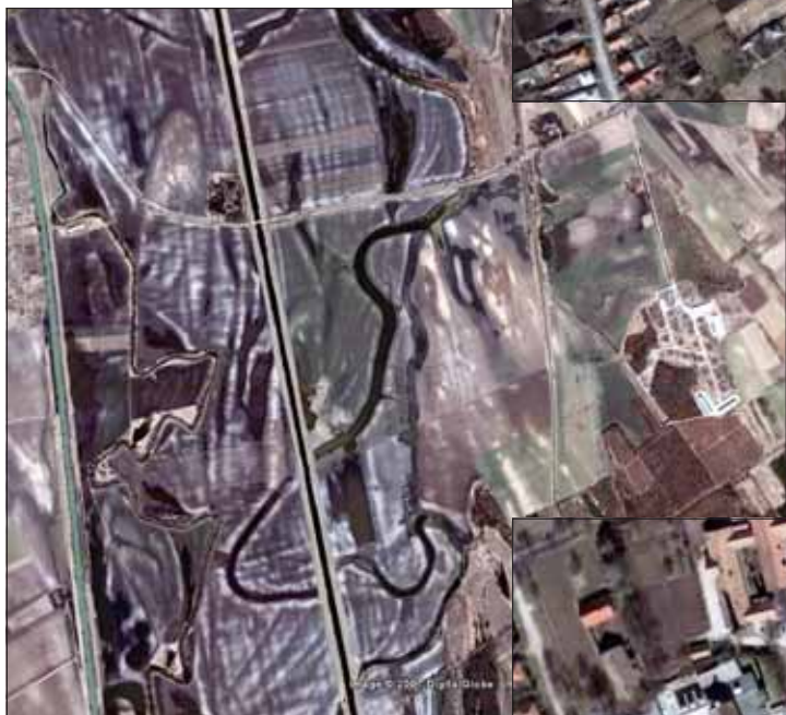
Az egyenes vonal a mai Sárvíz-csatorna. A kanyargós pedig a több mint száz éve lecsapolt régi meder, amiben még ma is folyik a víz a szántóföldek alatt.
