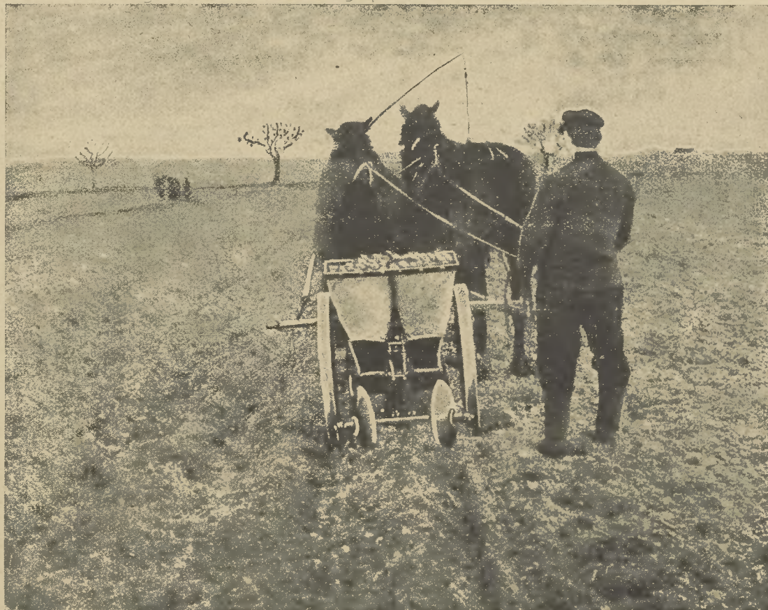
36-ik ábra. Aspinwall-féle burgonyaültető-gép működésben.
