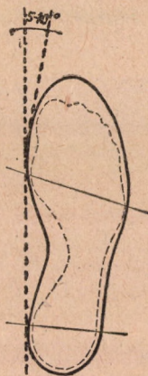
5. sz. ábra: A kaptafa talpformája a talp lenyomatával a bűtyök- és sarokvonallal
