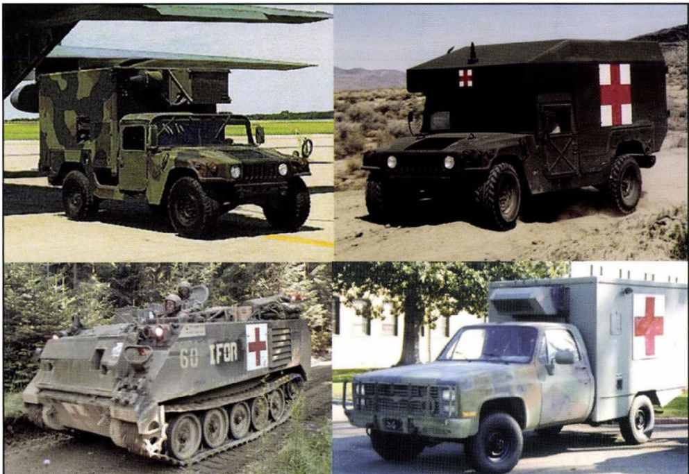
1. ábra: A szárazföldi kiürítés során alkalmazott járművek (balra fent: M996; jobbra fent: M997; balra lent: M113; jobbra lent: M1010)
