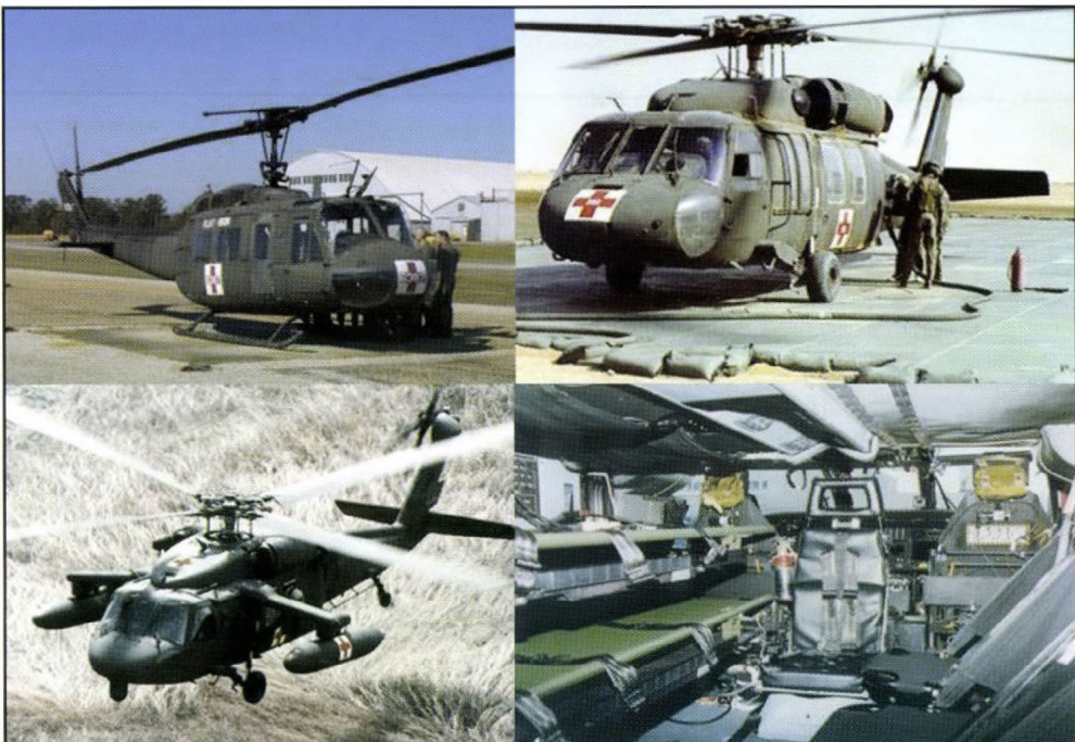
2. ábra: A légi kiürítés során alkalmazott repülőeszközök (balra fent: UH-1V; jobbra fent: UH-60A; balra lent: UH-60Q; jobbra lent: az UH-60Q belső tere)
