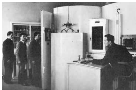
21. ábra. A budapesti barokammera vezérlőpultja. A bejáratnál a jelöltek hipoxiás vizsgálatra készülnek.
