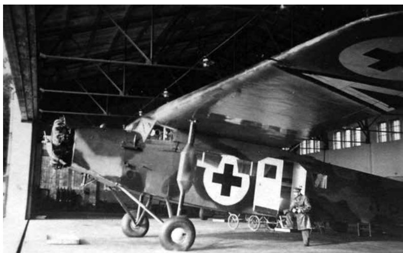
11. ábra. Terepszínű hadifestést kapott a Fokker 1938-ban, a Kisantanttal kötött Bledi Szerződés után, amikor elismerték Magyarország egyenrangú fegyverkezési jogát. A gép szárnyának alsó felületén látszik a vöröskeresztes jel mellett a 1938–1942 között alkalmazott magyar katonai hadijel, a nemzeti színekből összeállított ékjel. A gép belső terei, az egészségügyi előírások szerint fehér színre vannak festve, ez jól látszik a kinyitott utasajtón [5].
