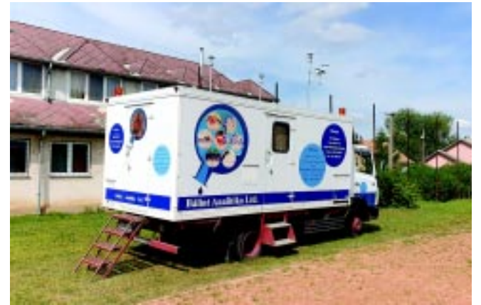
Az ilyen, úgynevezett immissziós mérőkocsi segítségével rögzítik a levegő alapállapotát
