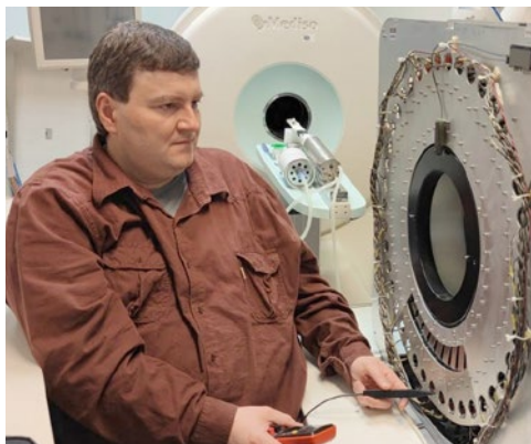
Pozitron Emissziós Tomográf (PET) berendezés javítása a SOTE kísérleti laborjában
