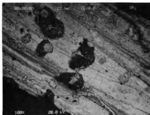
17. ábra Iternésken (fekete), Sb-oxid , Sb-Fe-oxid (szürkésfehér) antimonit-kristály felületén. Gyöngyössolymos. SEM-felvétel
