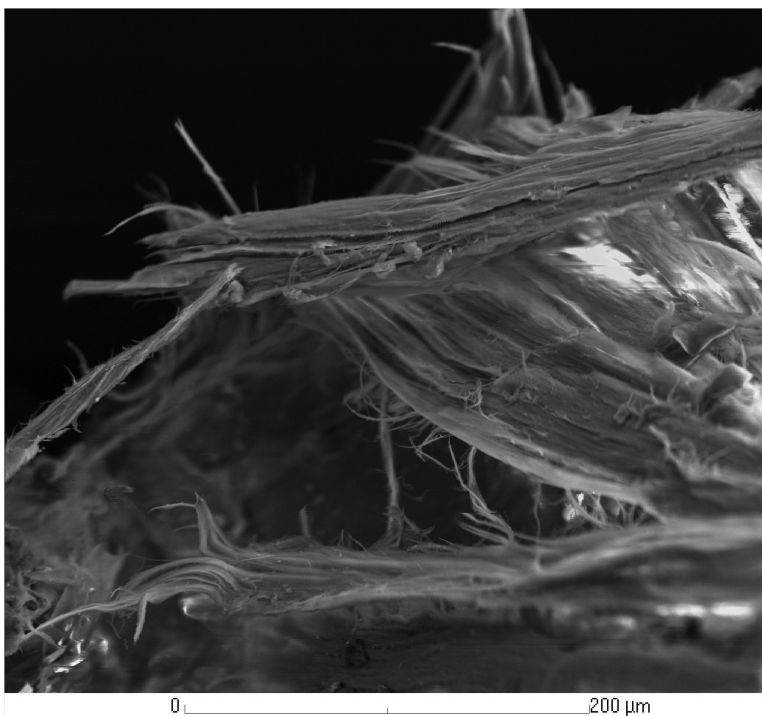
3. ábra. Girbegurba szepiolitszálak, melyek hajlékonyak, de nem rugalmasak. Pásztázó elektronmikroszkópos felvétel. Fotó: Zajzon Norbert.
