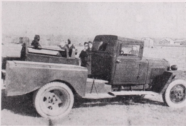
6. kép. Az aerosztátion csörlő berendezése
