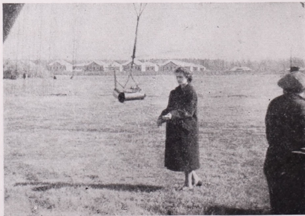
4. kép. Aerosztátra függesztett meteorográf
