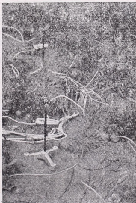
2. ábra. A bogyó hőmérsékletének mérése termisztorral (bogyó a talaj felszínétől 15 cm magasságban)
