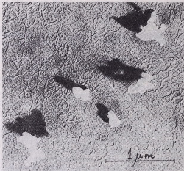
6. ábra. A kaszkád-impaktor negyedik fokozatán felfogott AgI aeroszol-részecskék elektronmikroszkópos képe
