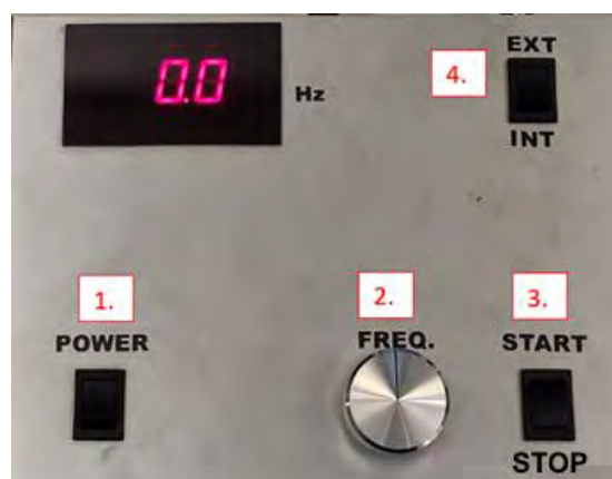
Figure 6. Control Panel; Source:Norbert Bíró
