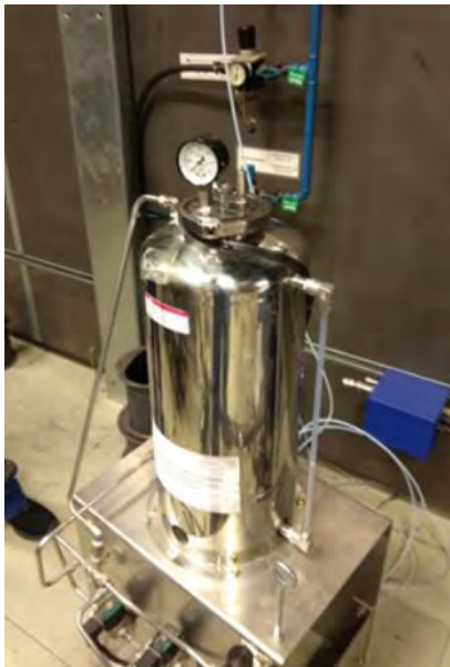
Figure 4.: Adblue dosing unit; Source: Norbert Bíró
