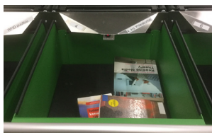
▲ Az automata könyvvisszavételhez tartozó futószalag tematikusan leválogatja a különböző raktárakba ▼ helyesrögzítendő könyveket.
