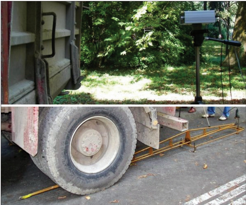
5. ábra: A műszeregyüttes a gyakorlatban Figure 5: Advanced Benkelman Beam Apparatus in the field
