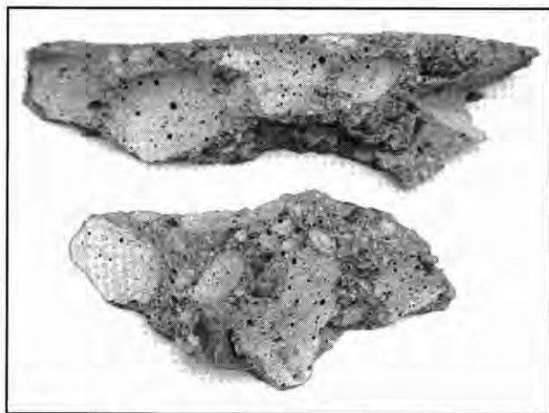
2. ábra A buborékok helye a megszilárdult betonban
