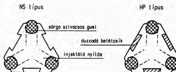
A Sika Injectoflex rendszer injektáló csövei
