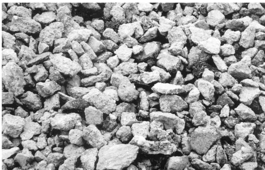
2. ábra Bontott betontörmelék
