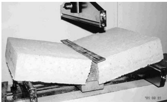
12. ábra Mederlap hajlító-húzószilárdság vizsgálata
