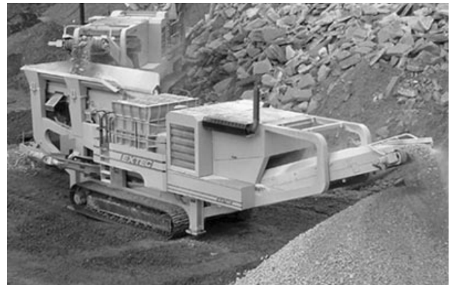
2. ábra Dolgozik az Extex mobil hengeres törő
