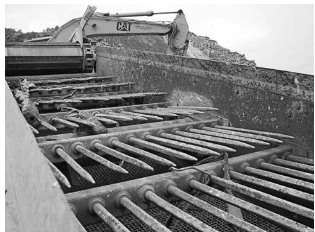
3. ábra Szurony alakú rostélyrudak, melyen az anyag többször átfordulva halad lefelé, eközben a ráakódott föld leválasztódik
