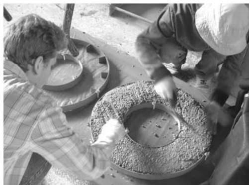
1. ábra Szálerősítésű beton bedolgozása a „Richtlinie Faserbeton” szerinti vizsgáló gyűrűbe
