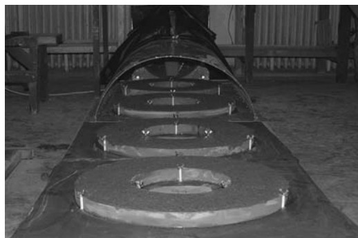
2. ábra Forszírozott szárítás a repedésképződési hajlam vizsgálatára
