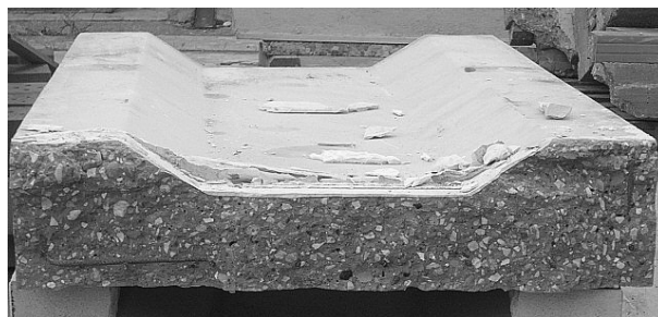
5. ábra Vasalt folyóka elem törési felülete
