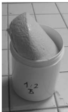
3. ábra 1:2 keverési arányú gél jelentős térfogatváltozása
