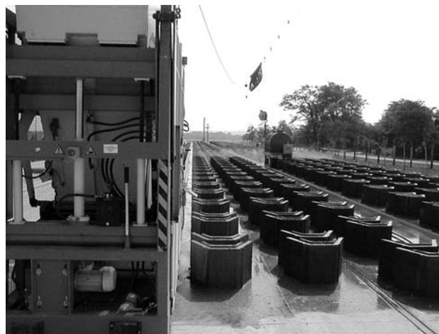
1. ábra Árokburkoló elemek gyártása
