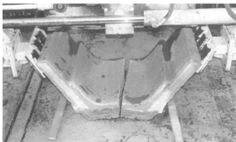
2. ábra Árokburkoló elem törővizsgálata
