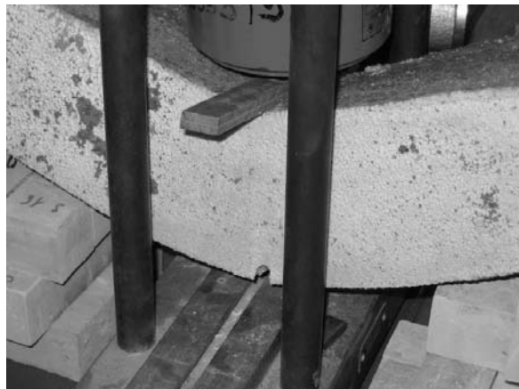
5. ábra A húzott szélső szál szakadása; 1. minta
