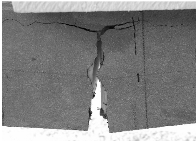
4. ábra A hajlítási töréskép
