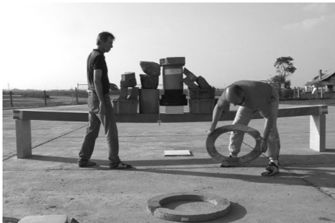
3. ábra A próbaterhelés során közel 700 kg kellett a tönkremenetelhez
