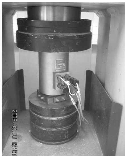
2. ábra A gömbcsukló vizsgálatához használt cella
