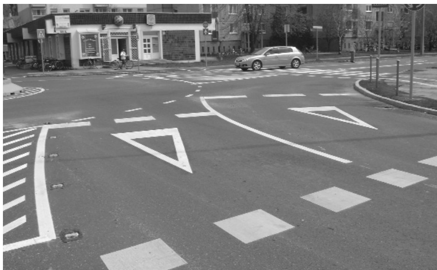
4. ábra Az egyenes-balos és a jobbra kanyarodó forgalmi irány belépési pontjának részlete az egyirányú kerékpárút átvezetésével
