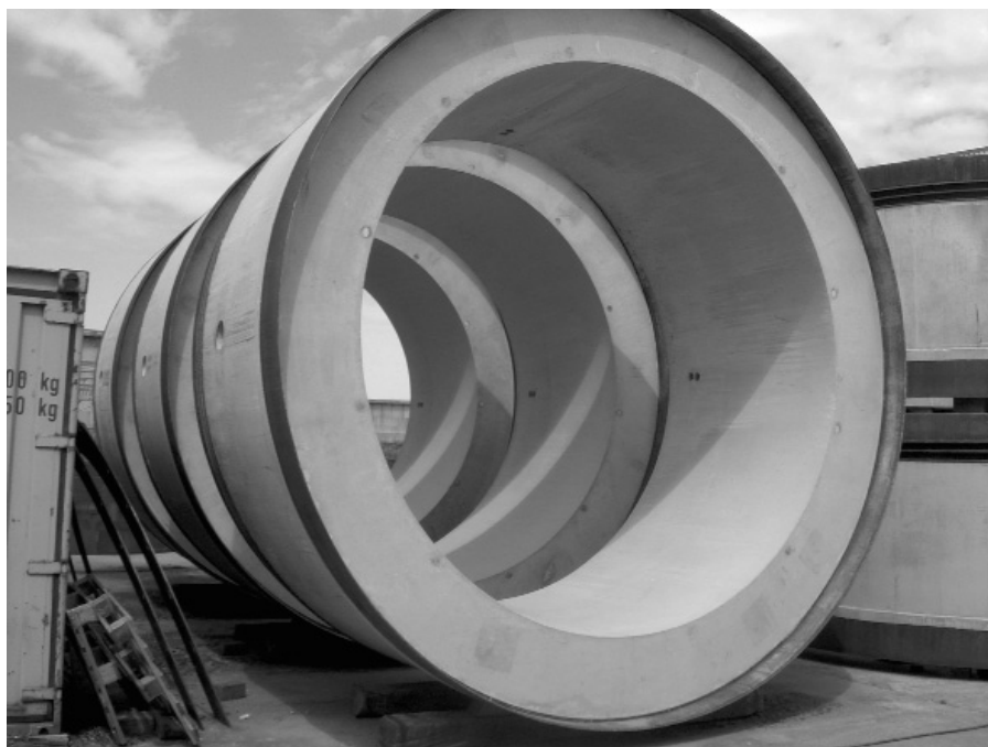
4. ábra Centrilic NC-vel készült vasbeton gyűrűk
