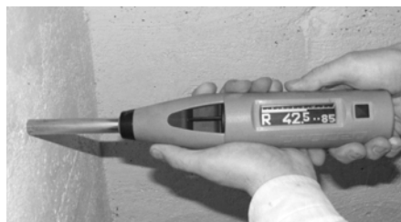
1. ábra. Az N-típusú Silver Schmidt-kalapácsoló
